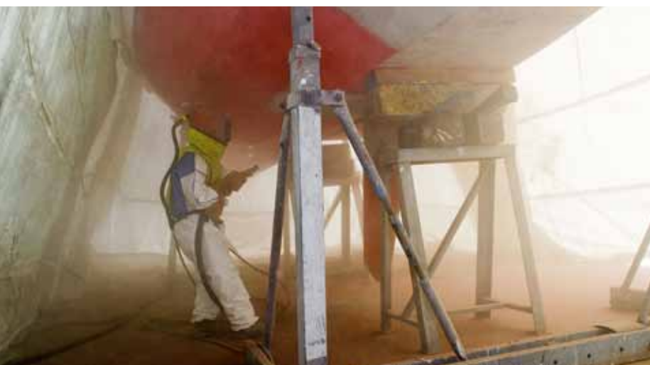
Les bâches couvrant l'intégralité de la coque empêchent les poussières de se répandre autour de la zone de ponçage.
