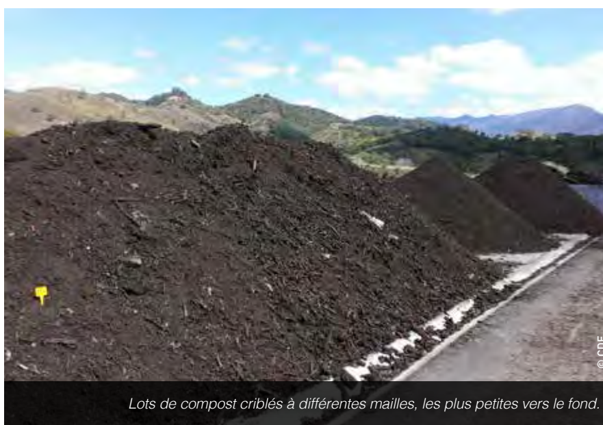
Le tamisage du compost est la dernière étape avant son évacuation de la plate-forme.
